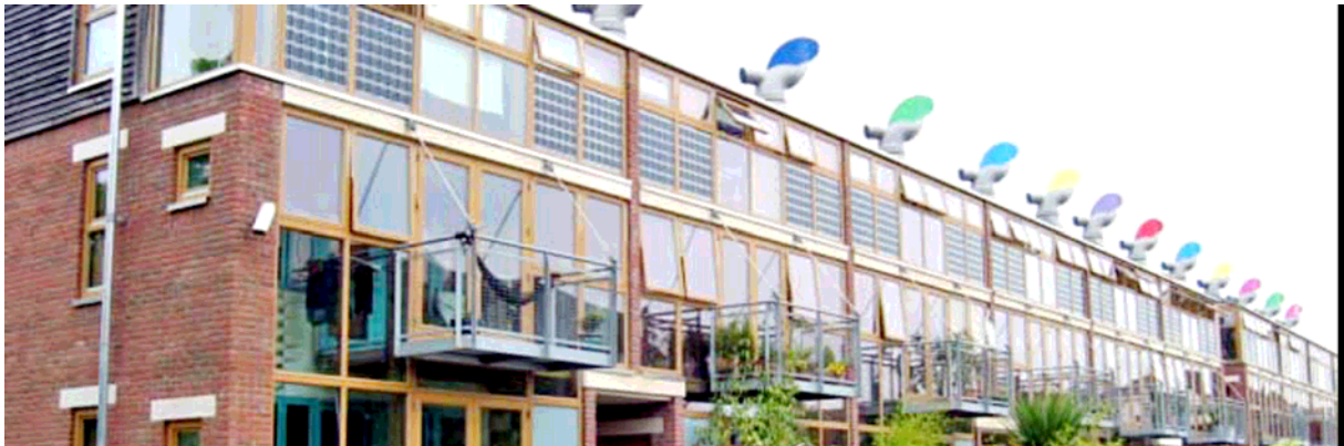
Vue des bâtiments mixtes habitation-bureaux, orientés pour capter au maximum la chaleur et ventilés naturellement par ces cheminées-girouettes colorées, symboliques de BedZED.
